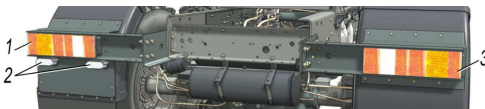
1, 3-фонарь задний (габаритный огонь/светоотражающее устройство/указатель поворота/сигнал торможения/фаара заднего хода/задний противотуманный фонарь); 2-фонари освещения номерного знака
