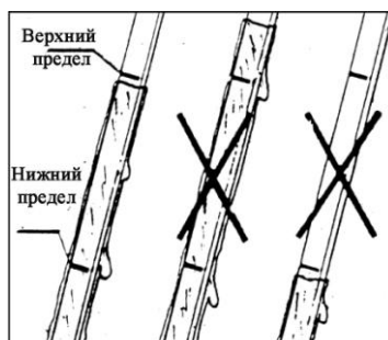
Рис.14 Проверка ёмкости масляного бака
