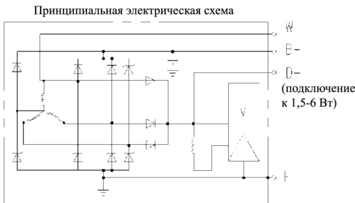
Рис. 24 Принципиальная электрическая схема генератора
