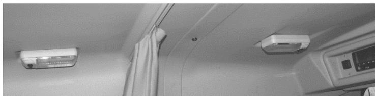
Рисунок 4.1.2 - Плафоны освещения внутри кабины
