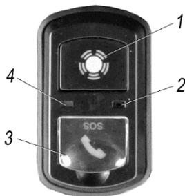
1-кнопка «Дополнительные функции» с подсветкой; 2-микрофон; 3-кнопка «SOS» с подсветкой и защитной крышечкой; 4-индикатор состояния
