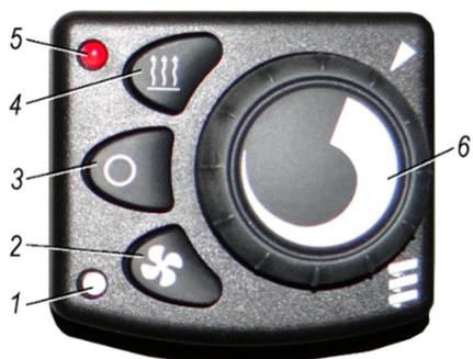
1-синий СИД-контроль работы вентиляции; 2-кнопка «Вентиляция»; 3-кнопка «Отключение»; 4-кнопка «Обогрев»; 5-красный СИД-контроль работы обогрева; 6-регулятор регулировки температуры
